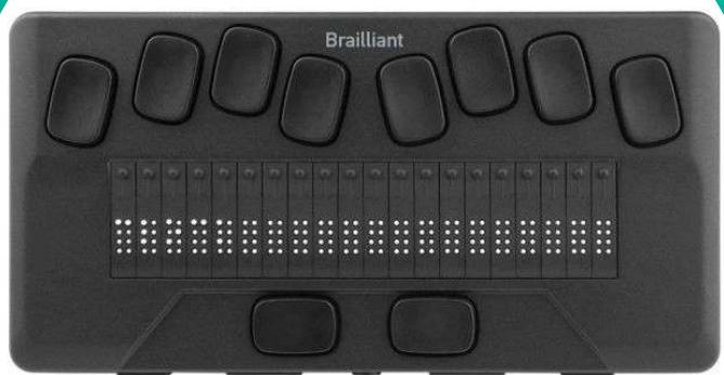
Brailliant BI 20X è un dispositivo braille pratico e versatile. Può essere usato in modo autonomo, senza essere collegato ad un PC, grazie all'editor di testi integrato, alla calcolatrice, al file manager che permette la copia, lo spostamento e l'eliminazione di file di testo nei formati più comuni. E' inoltre possibile usare chiavette USB e schede SD.
