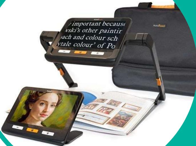
Explorē 8 è un videoingranditore portatile con schermo touch da 8" e con telecamera HD autofocus. Questo dispositivo permette di ingrandire testi e oggetti fino a 30x, con la scelta tra 17 differenti modalità di visualizzazione per scritte e sfondo.
