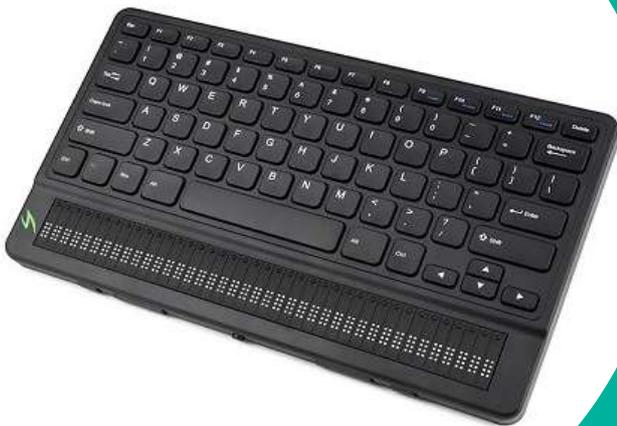
Mantis Q40 è un dispositivo braille che, grazie alla batteria e alla tastiera integrate, può essere utilizzato anche senza essere collegato ad un PC, ha un editor di testi integrato, una calcolatrice e la gestione dei file per la copia, lo spostamento e l'eliminazione di file di testo nei formati più comuni. E' inoltre possibile usare chiavette USB o schede SD.
