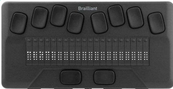
Brailiant BI 20X è un dispositivo braille pratico e versatile. Può essere usato in modo autonomo, senza essere collegato ad un PC, grazie all'editor di testi integrato, alla calcolatrice, al file manager che permette la copia, lo spostamento e l'eliminazione di file di testo nei formati più comuni. E' inoltre possibile usare chiavette USB e schede SD.
