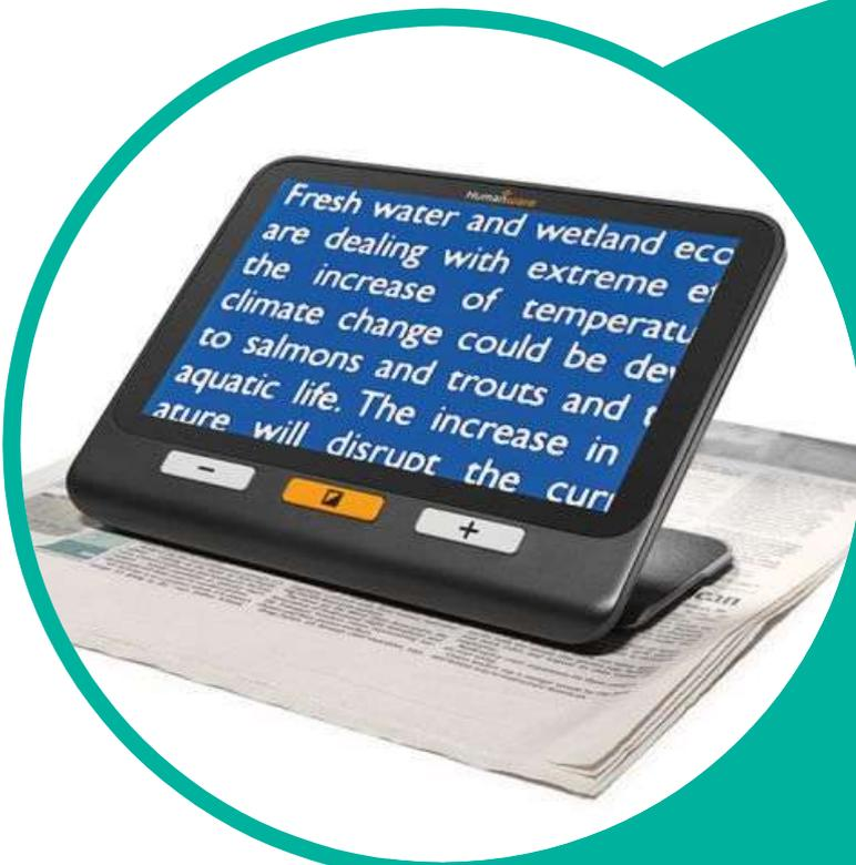
Explorē 8 è un videoingranditore portatile con schermo touch da 8" e con telecamera HD autofocus. Questo dispositivo permette di ingrandire testi e oggetti fino a 30x, con la scelta tra 17 differenti modalità di visualizzazione per scritte e sfondo.
