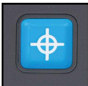
Premendo il pulsante quadrato blu per tre secondi si attiva un puntatore rosso a LED sul piano di lettura. Il puntatore consente di individuare il punto dove la telecamera sta puntando. Quando si scrive, se si posiziona ad esempio una penna sull'indicatore luminoso rosso, si vedrà la penna visualizzata al centro dello schermo. Premere ancora una volta il pulsante per spegnere la luce a LED. Dopo 30 secondi, il puntatore verrà automaticamente disattivato.
