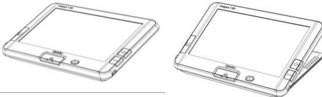
In posizione aperta, lo schermo sarà inclinato con un angolo di visione adatto per la lettura, con la telecamera rivolta verso il basso. La posizione aperta permette di leggere testi più lunghi, grazie al supporto di lettura integrato.
